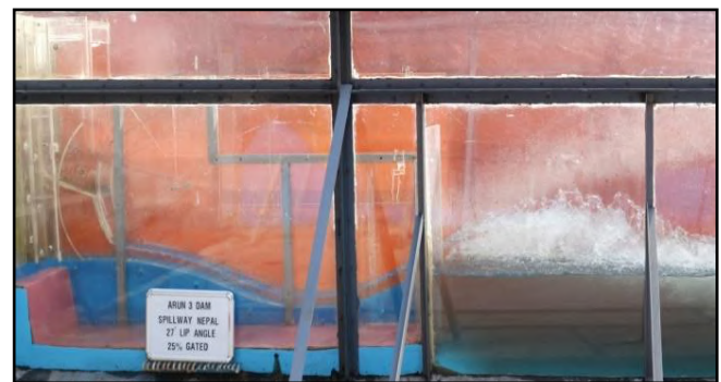
अधिप्लव पर द्वारयुक्त संचालन में 25% अभिकल्पित निस्सरण के लिए अधिप्लव और ऊर्जा क्षयकारक का प्रदर्शन
