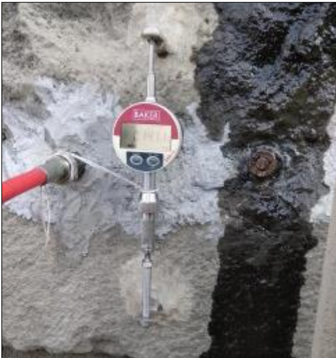
चित्र 1. वालवान बांध में फ्लैट जैक परीक्षण प्रगति पर
