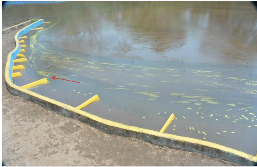
49323.9 m 3 /s के निर्वहन के लिए स्पर्स के पास विशिष्ट प्रवाह का स्वरूप
