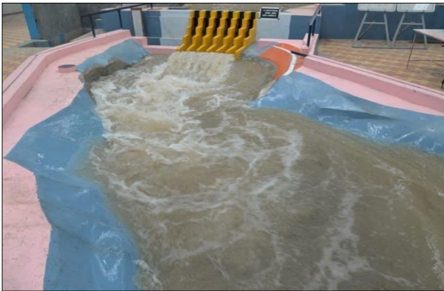
द्वार प्रचालित मुख्य उत्प्लव मार्ग के लिए प्रवाह की स्थिति 13000 घनमी./से.(100%) , पूर्ण जलाशय स्तर 755 मीटर
