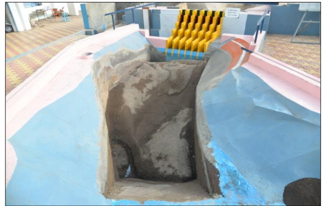
द्वार प्रचालित मुख्य उत्प्लव मार्ग के लिए कटाव का स्वरूप 13000 घनमी. /से. (100%) , पूर्ण जलाशय स्तर 755 मीटर
